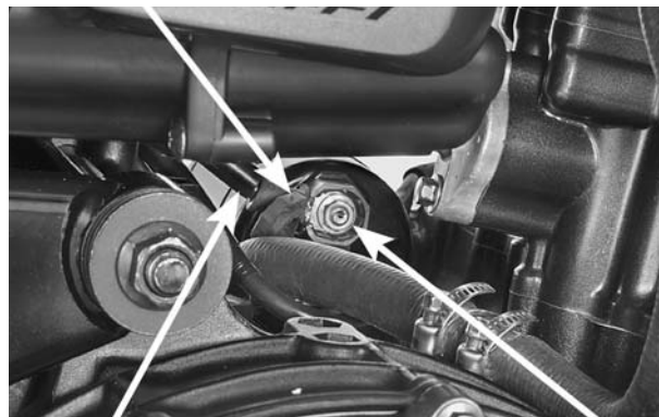
CABO DO MOTOR DE PARTIDA PORCA DO TERMINAL MOTOR DE PARTIDA CABO DO TERRA
